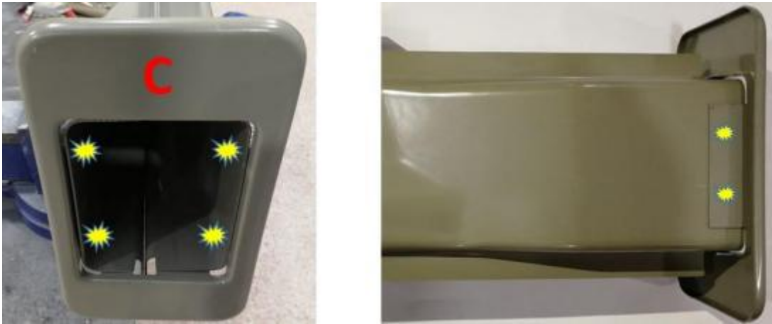
模拟纵梁前端板分离示意图(图 B-6)
